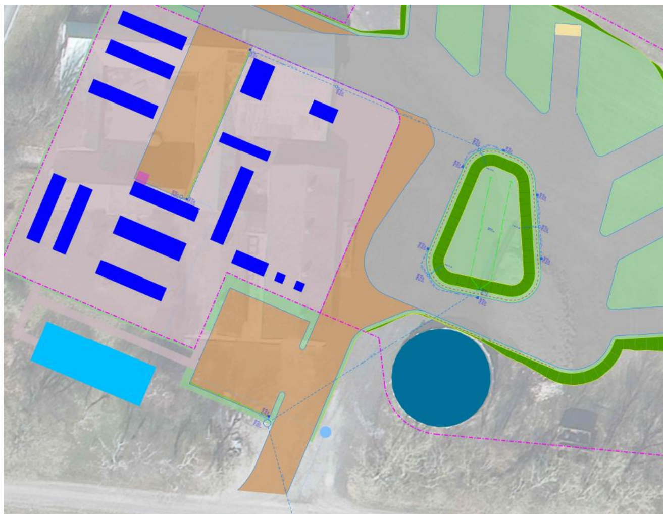
Figur 6 Afløbssystem til bortledning af overfladevand fra befæstet areal. Opstuvningsbassin ses i midten af det befæstede område.
