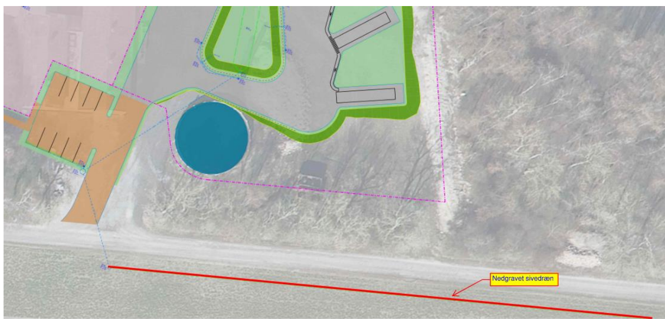
Figur 10 Skematisk illustration af trace for nedsivning. Sivedrænet er fremhævet med rød streg.
