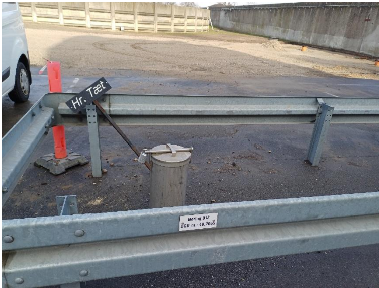
Billede 6: Boringsprøvetagning B18. Sikret mod påkørsel med hegn. I baggrunden af billedet ses, hvor forsinkelsesbassinet plejede at være.
