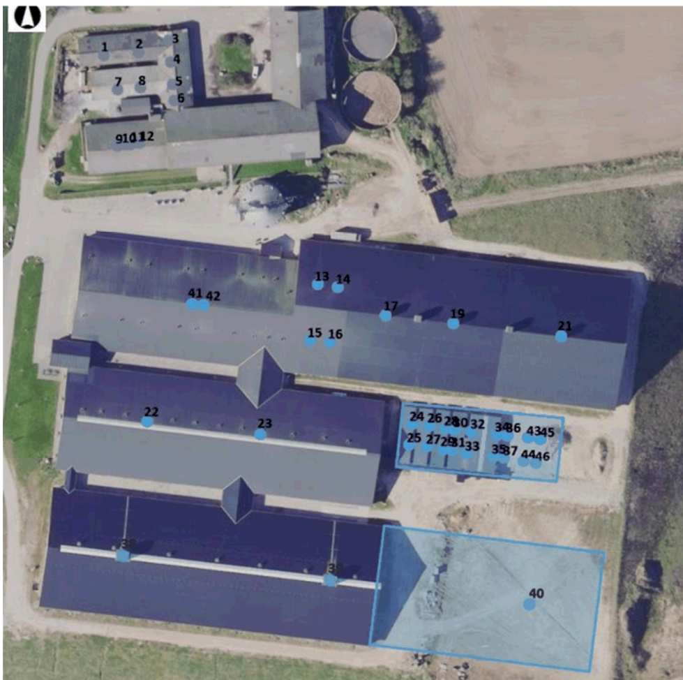
Figur 4: Placering af ventilationsafkast
