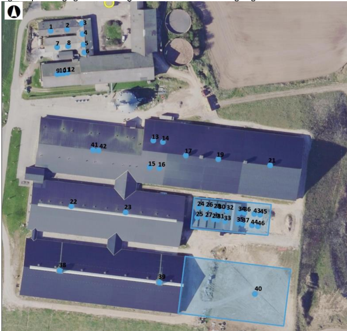
Figur 1: placering og nummerering af ventilationsafkast i beregningen
