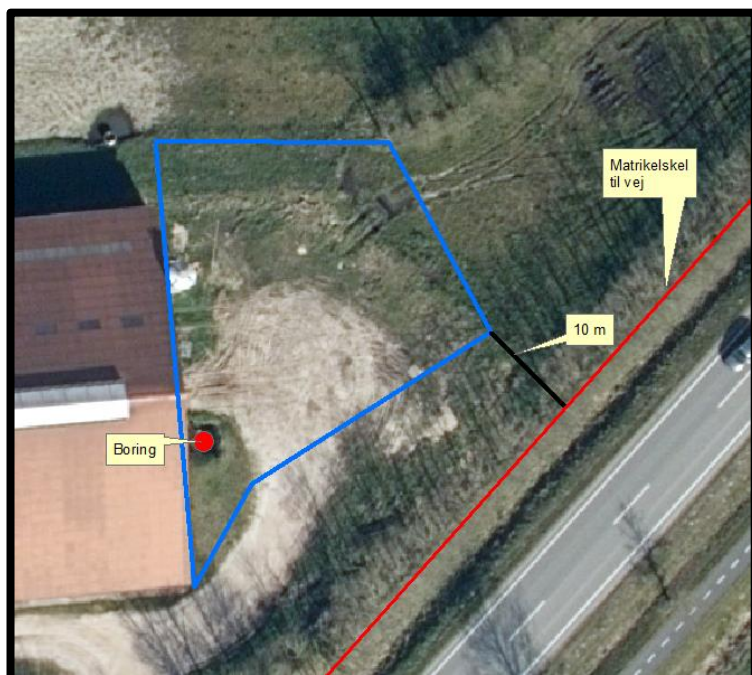
Figur 3. Manglende overholdelse af afstandskrav.
