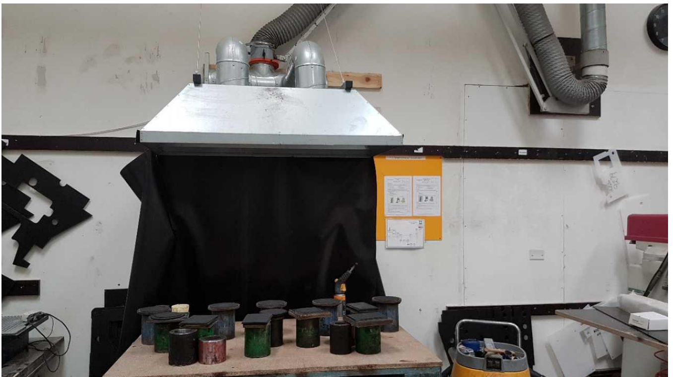
Punktudsug ved plads, hvor flossede kevlar-tråde brændes af.
