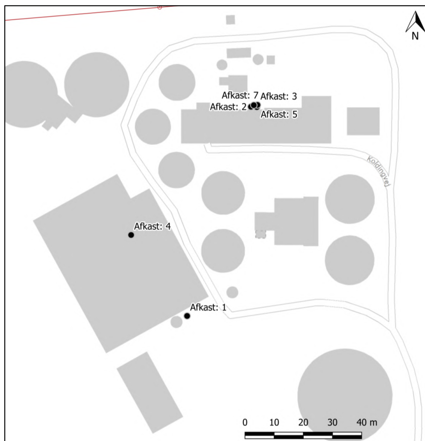
Figur 1 DTK skærmkort med nummerering af biogasanlæggets punktkilder til atmosfæriske emissioner. Af-kast 1 markerer biofilteret, afkast 2 markerer naturgaskedel (2.900 kW), afkast 7 markerer opgraderingsan-læg, afkast 4 markerer dampkedel og afkast 5 markerer naturgaskedel (800 kW). Afkast 3 og 6 findes ikke.
