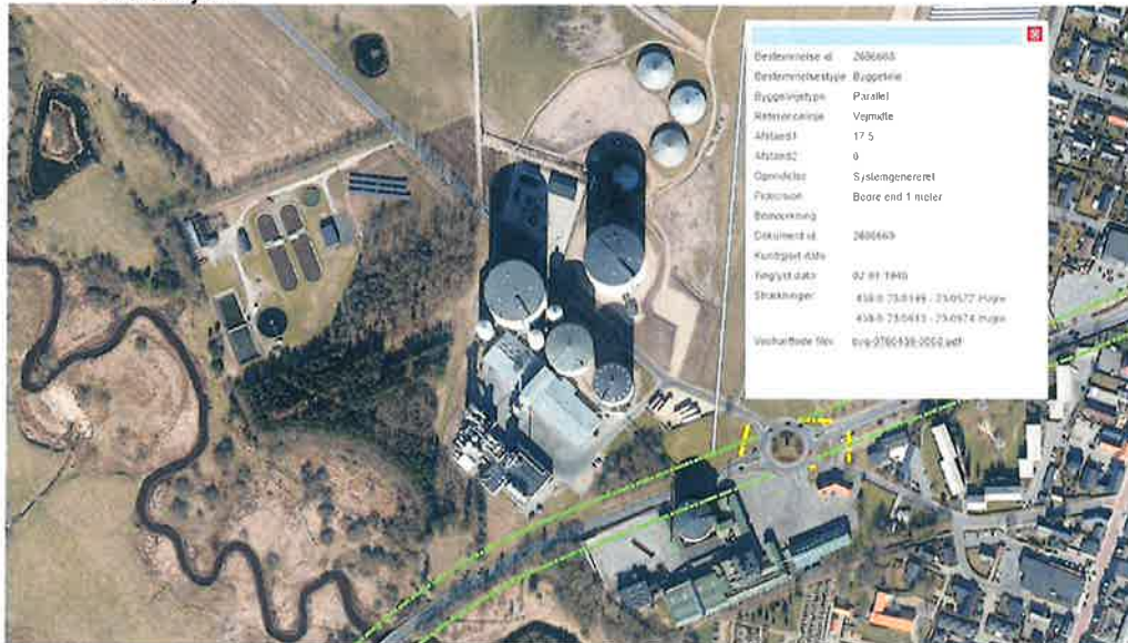
Figur 2: Luftfoto visende vejbyggelinjen - med grøn stiplede streg. Vejbyggelinjen er vist uden højde- og passagetillæg
