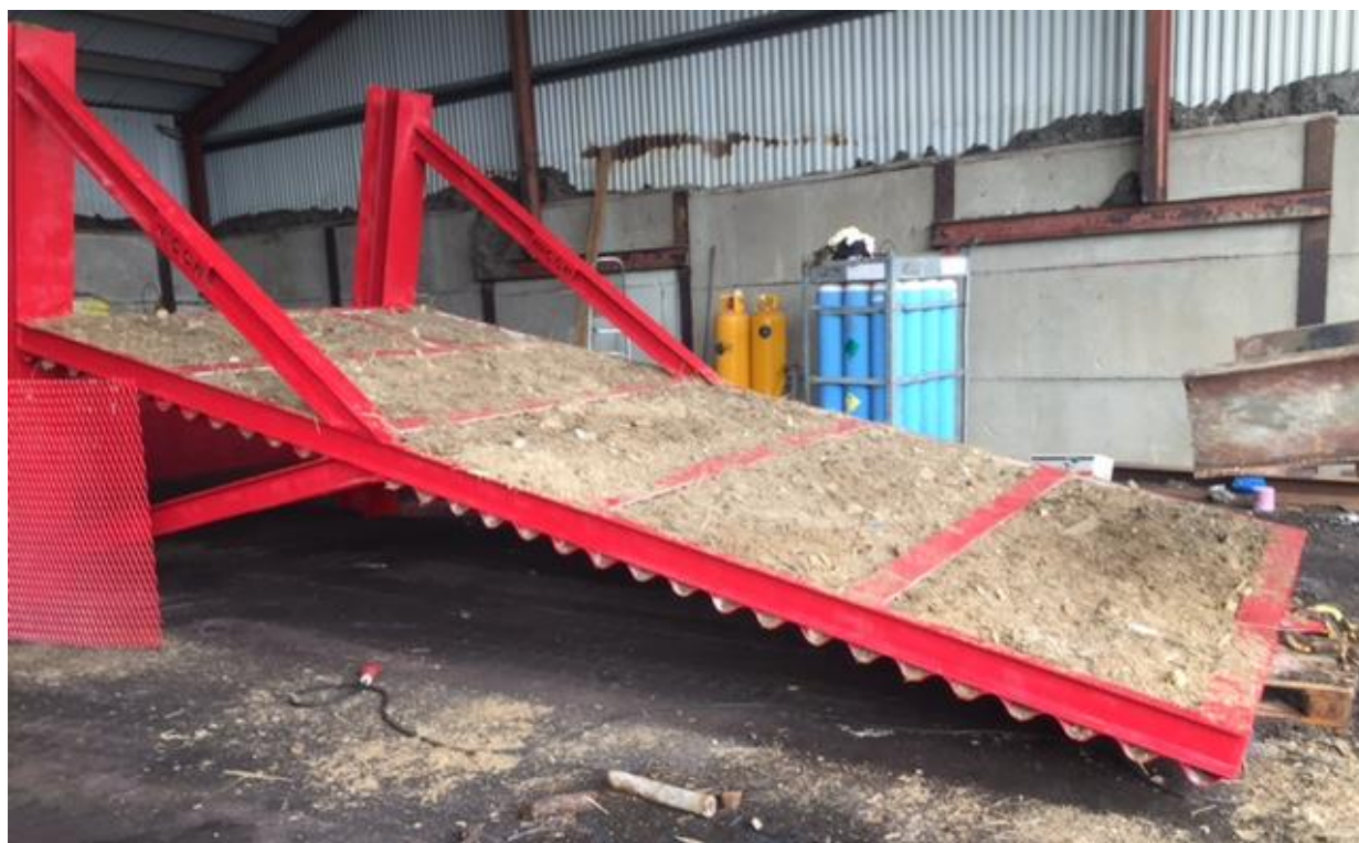
Billeder 2 og 3. Produktion af støjskærm med fyldning af knust glasfiber.
