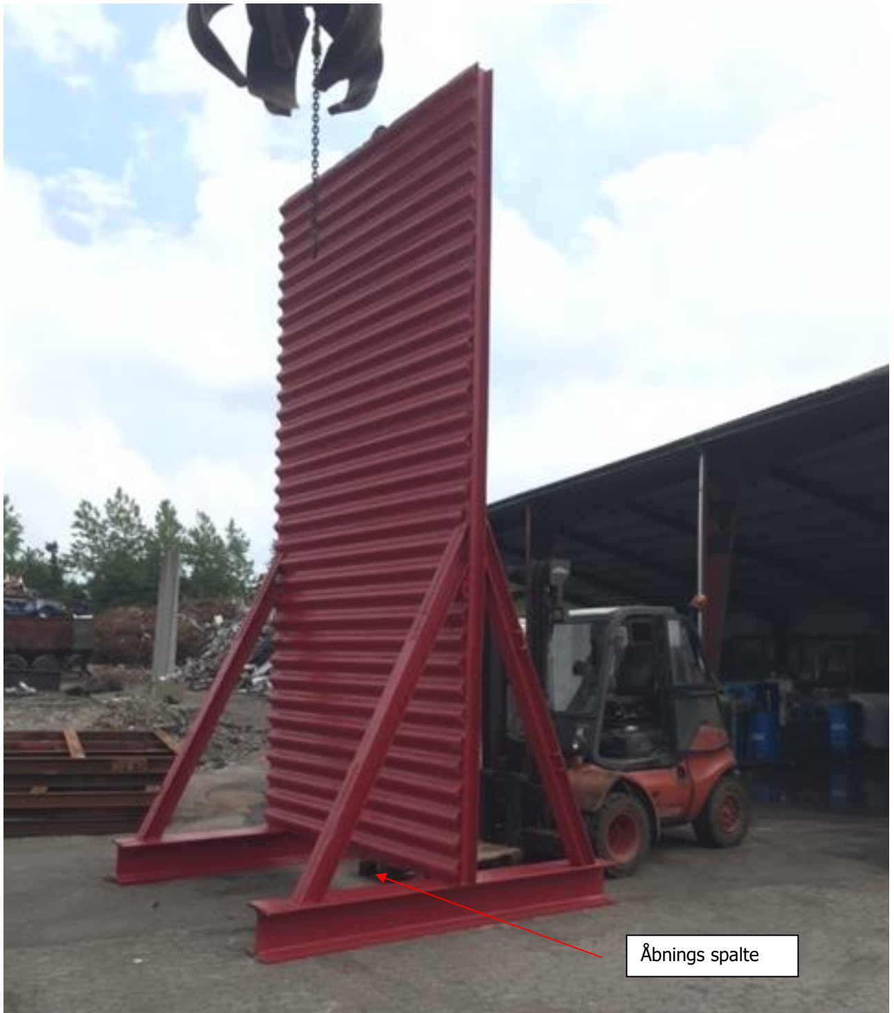
Billeder 4: Færdigproduceret mobil støjskærm (1 af 6 i alt) inkl. truck som flytter skærmen rund på pladsen.
