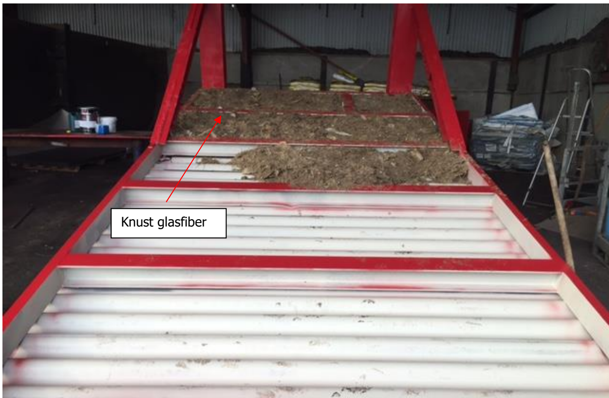
Billede 1. Produktion af støjskærm med fyldning af knust glasfiber.
