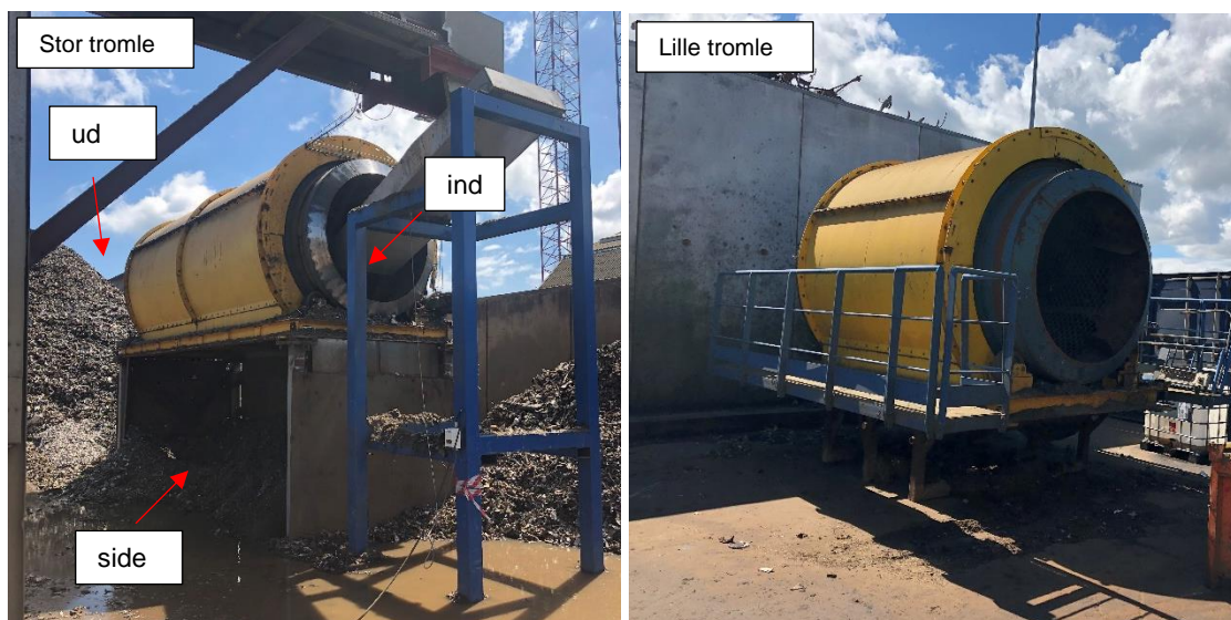
Figur 2 - Stor sorteringstromle (til venstre) i testopstilling. Den lille tromle skal stilles umiddelbart efter den store. STENA Grenaa, d. 16. juli 2020
