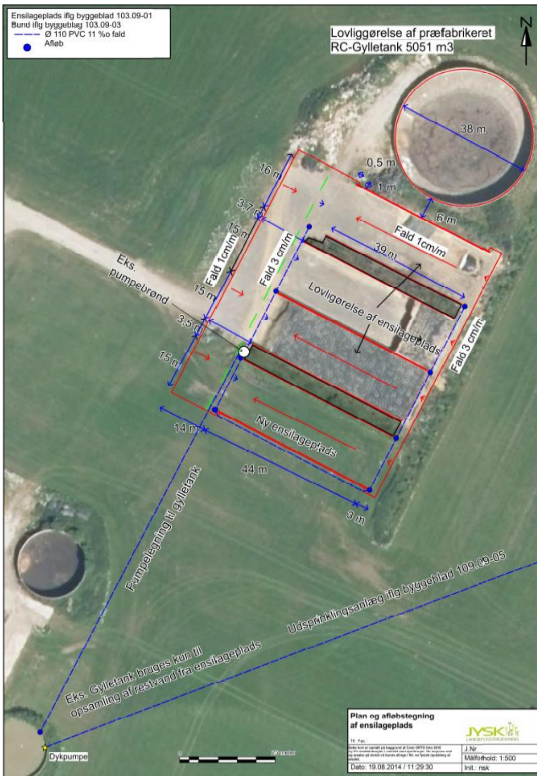
Figur 4. Afløb fra ensilageplads
