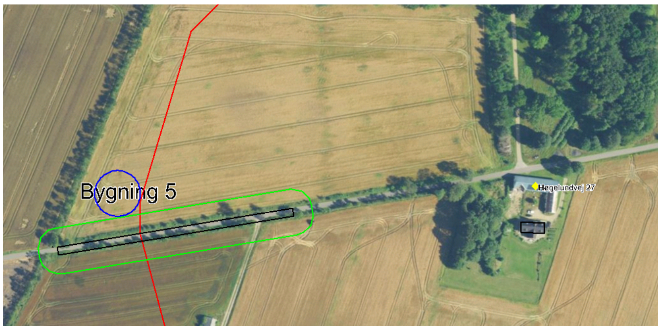
Figur 2c. Placering af den nye gyllebeholder. Rød markering viser at der er mere end 300 m fra nabo til gyllebeholderen og den grønne markering viser at afstandskravet til vej er overholdt.
