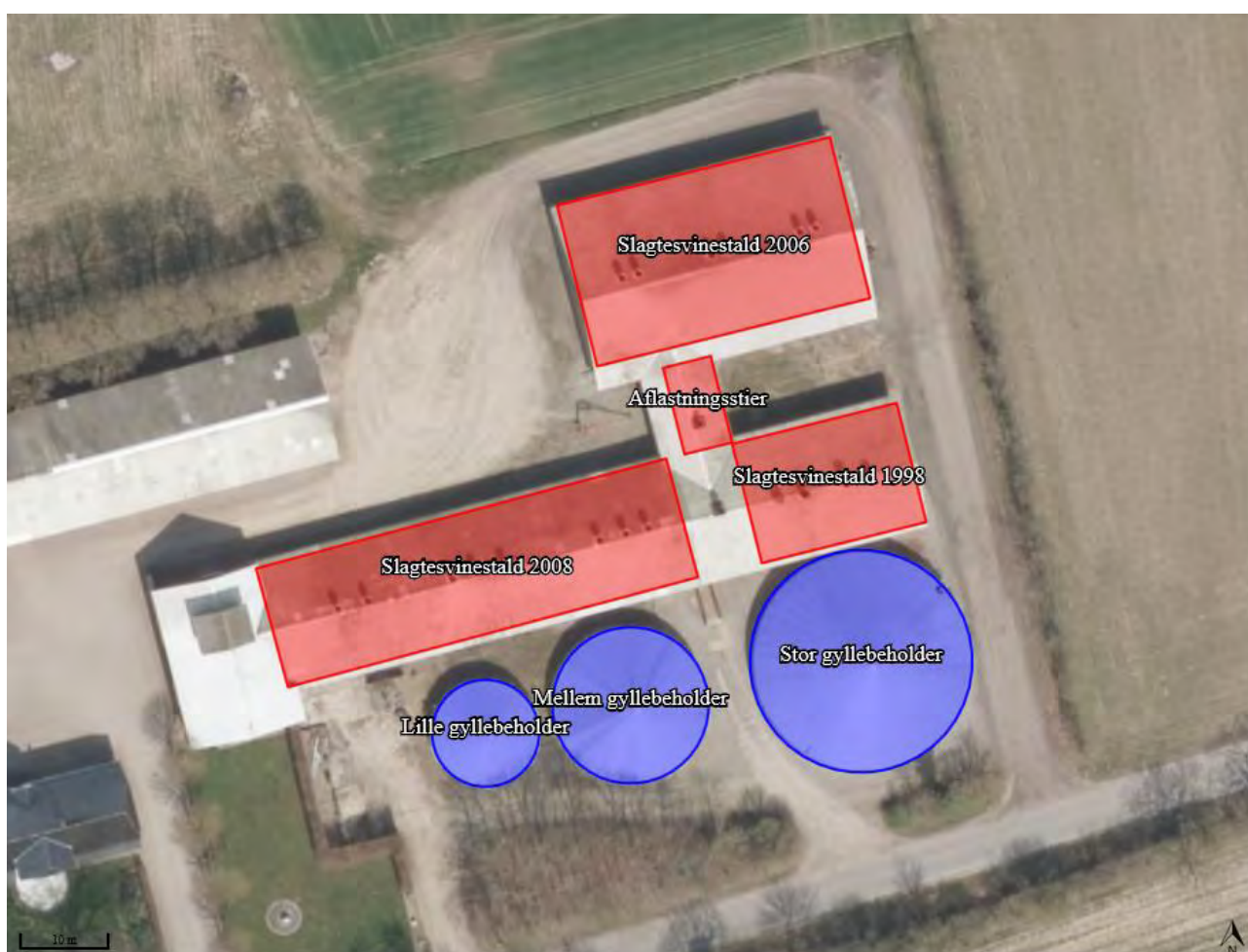
Figur 1 Husdyrbrugets stald- og opbevaringsanlæg
