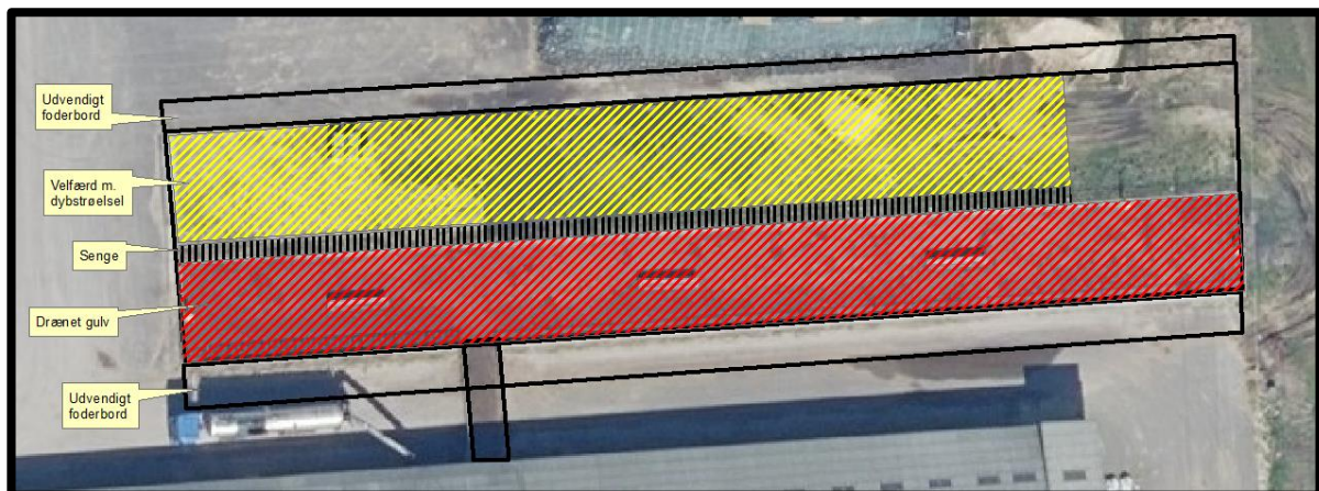
Figur 7. Sandsynlig indretning af bygning 22.
