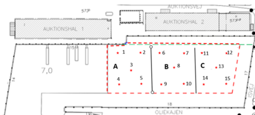
Figur 3-2 Kort over prøvestationer, fordelt i områder A, B, og C, for 15 nedstik i forskellige dybder (15 á 0-0,03 m under havbunden, 15 á ca. 1 m under havbunden).
