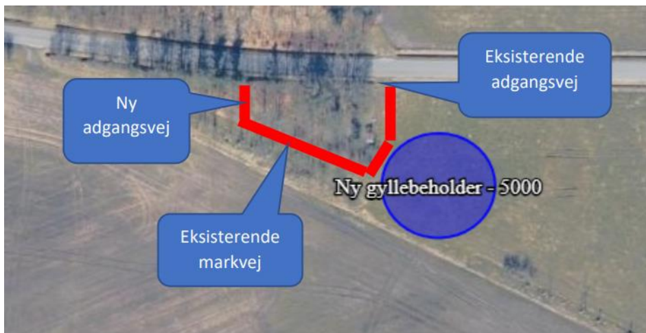
Figur 5.1. Den ny gyllebeholder, hvor der kommer en ny adgangsvej mod vest og den eksisterende adgangsvej gøres bredere. Figur udarbejdet af ansøger.
