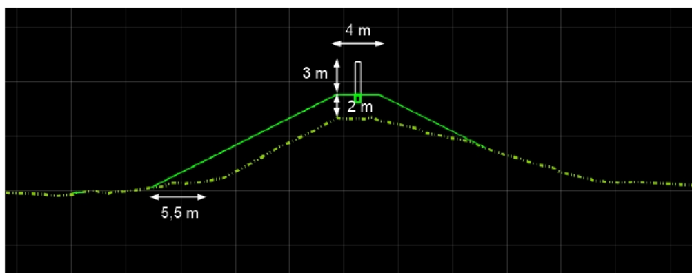
Figur 5: Udvidelse nord for Lyngvej. Den eksisterende støjvold udvides med mellem 5,5 m og 12 m i bredden. Herunder ses to eksempler på tværsnit gennem volden, der viser, hvor der indbygges jord.
