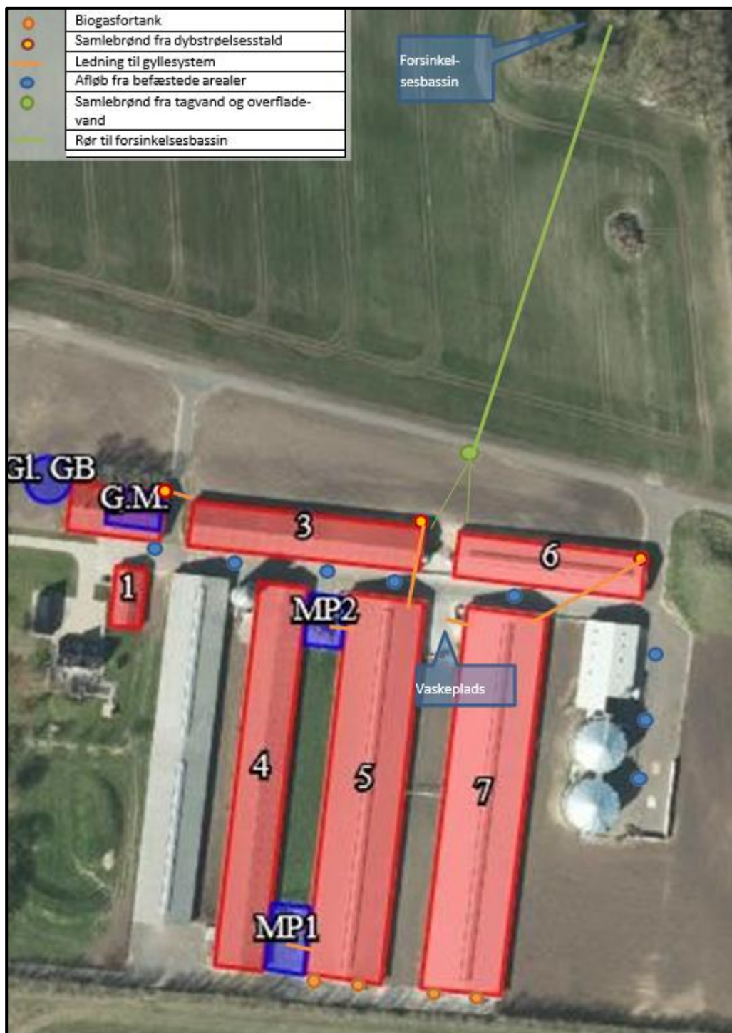
Figur 5. Afløbsplan udarbejdet af ansøger. MP2 er den nordlige møddingsplads som lovliggøres i denne miljøgodkendelse. Afløbsplan for denne møddingsplads er skitseret i figur 5.1.
