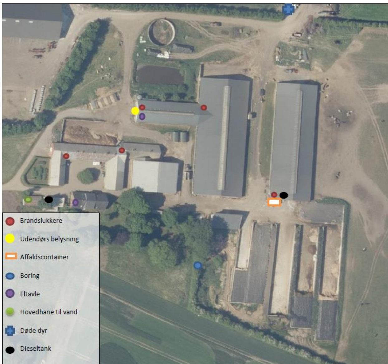
Figur 5. Oversigt over husdyrbrugets installationer og indretning.
