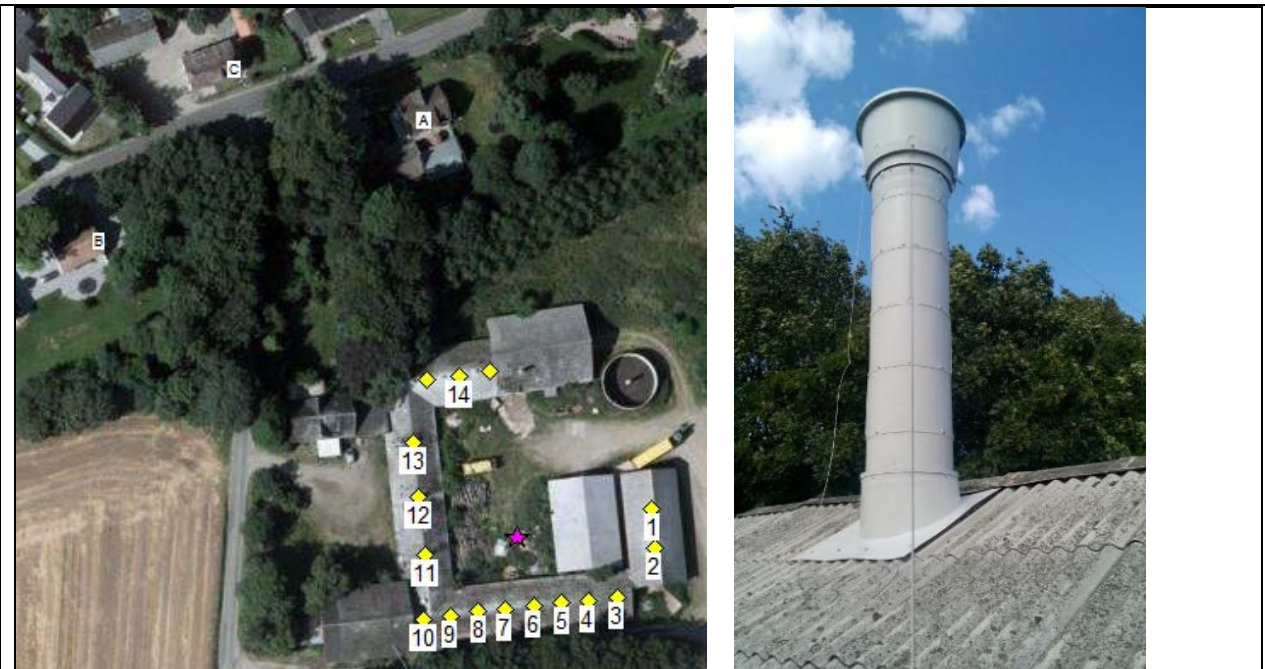
Figur 2. Resultat af OML beregning for beboelser i samlet bebyggelse samt billede af det forhøjede afkast.
