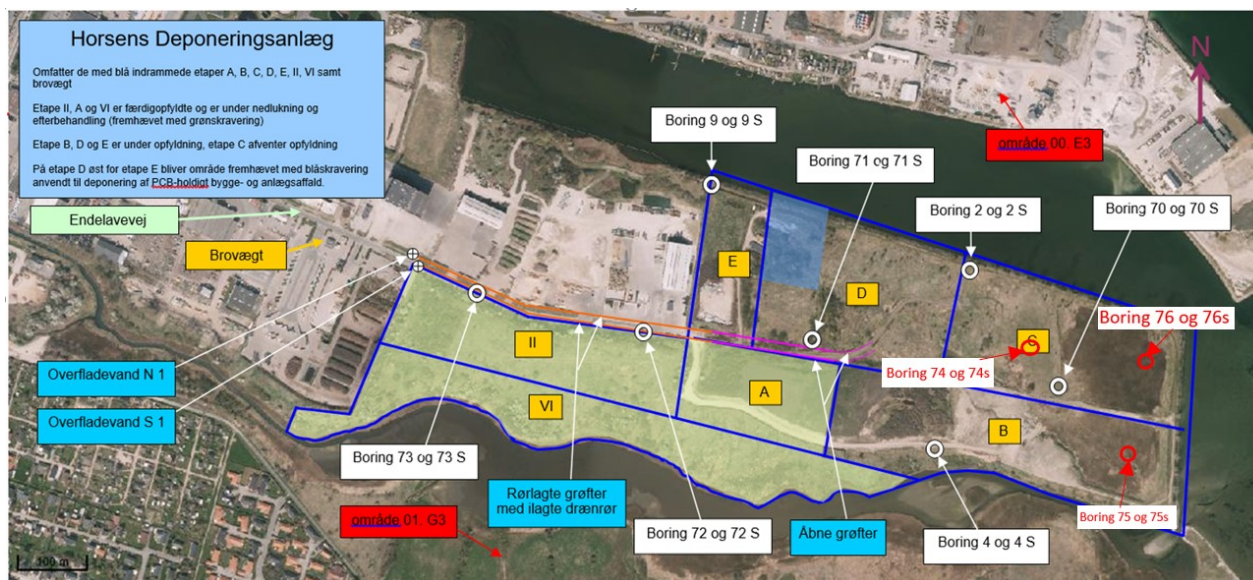
Figur 12. Oversigtskort over Horsens Deponi med angivelse af monitoringsboringernes placering /7/. Hvide cirkler angiver placeringen af eksisterende monitoringsboringer. Røde cirkler angiver forslag til placering af nye monitoringsboringer.
