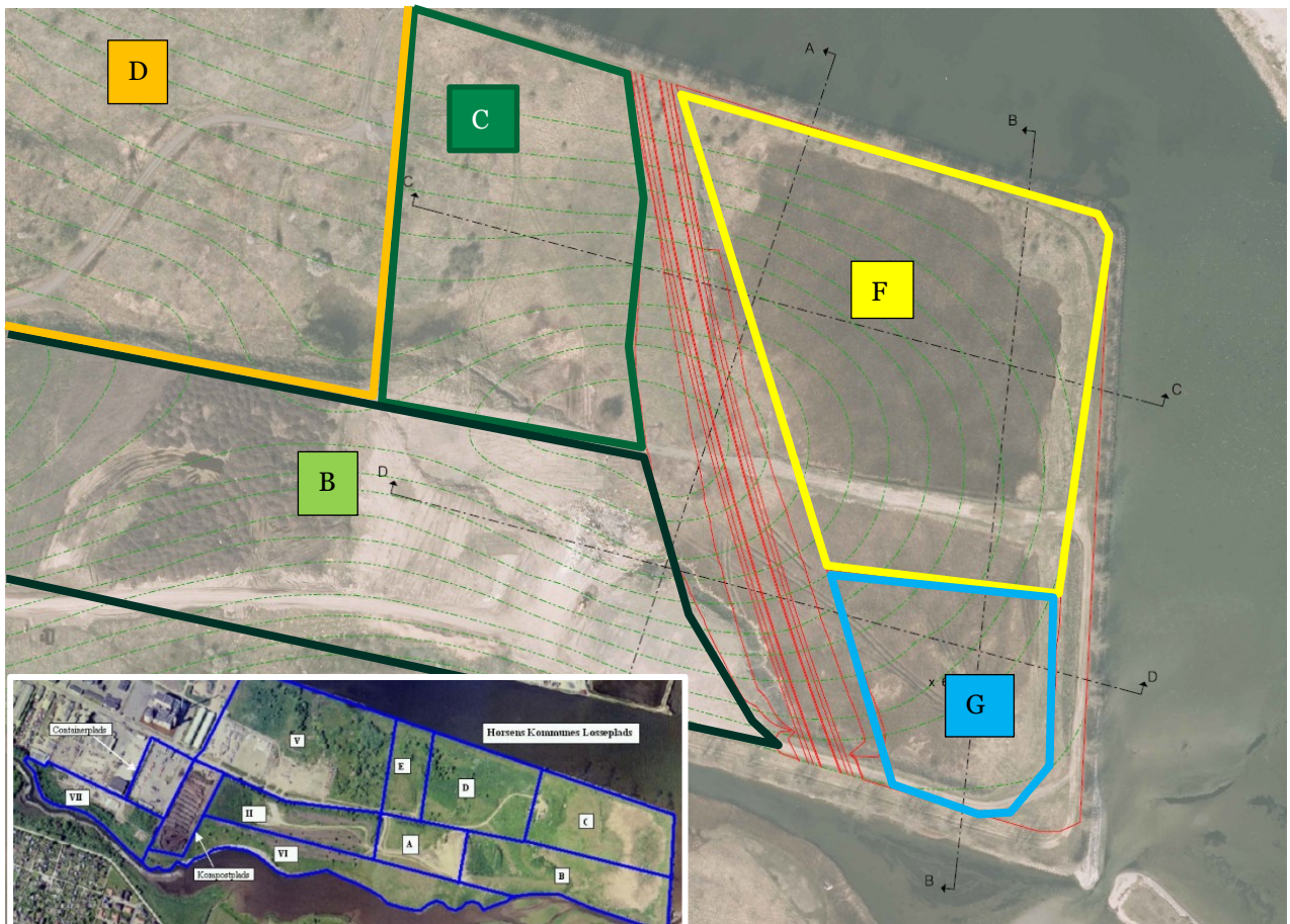
Figur 9. Fremtidig inddeling af Horsens Deponi i deponeringsetaper. I venstre hjørne ses den nuværende indretning taget fra figur 4.
