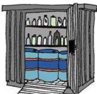
Figur 2 Udendørs opbevaring i container med dobbelt bund.
