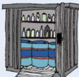
Figur 2: Udendørs opbevaring i container med dobbelt bund.
