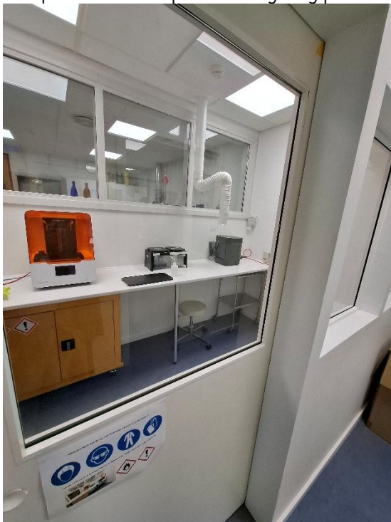
3-D printer med separat udsugning placeret i lukket rum
