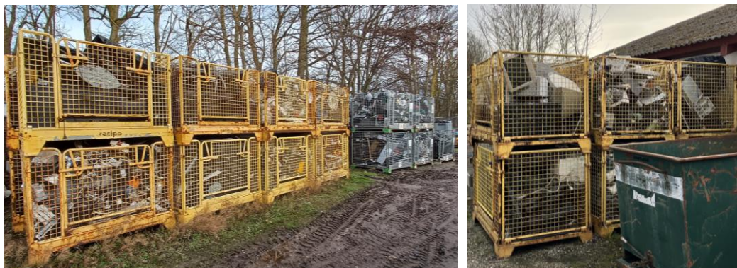
Affald af elektrisk og elektronisk udstyr (WEEE) opbevaret uden overdække på ubefæstet areal
