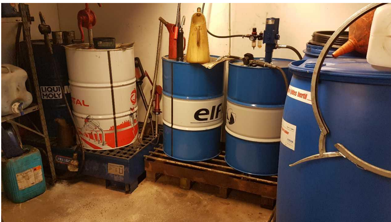
Råvarer opbevares på lageret med spildsikring.
