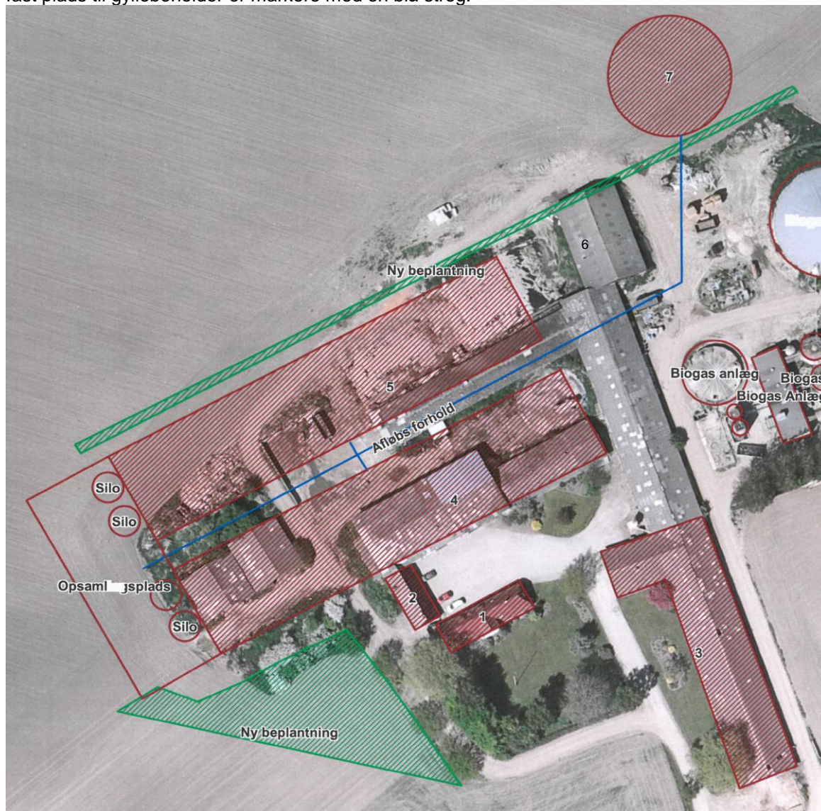
Figur 1. Oversigt over bedriftens anlæg ved ansøgt drift. De bygninger på Odensevej 252, der ikke er skraveret med rødt nedrives. De grønne skraveringer markerer beplantning. Afløbsforhold fra stalde og fast plads til gyllebeholder er markeret med en blå streg.
