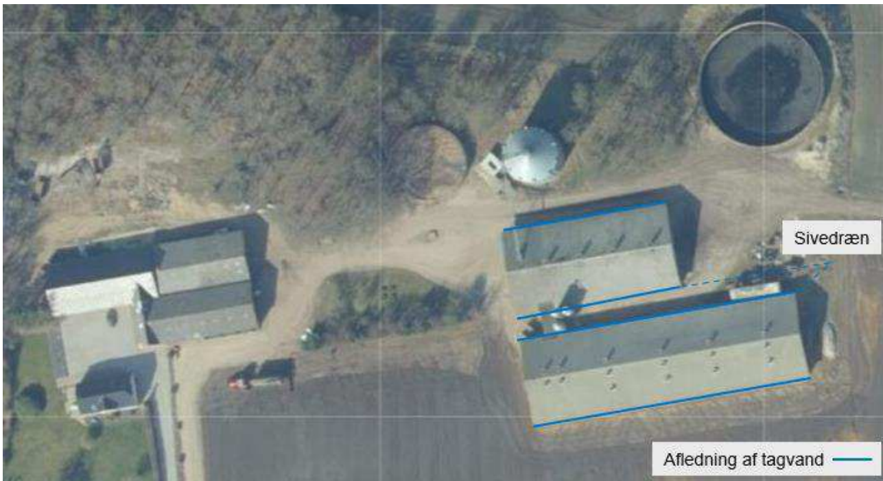
Figur 2. Afløbsledning af tagvand fra staldene
