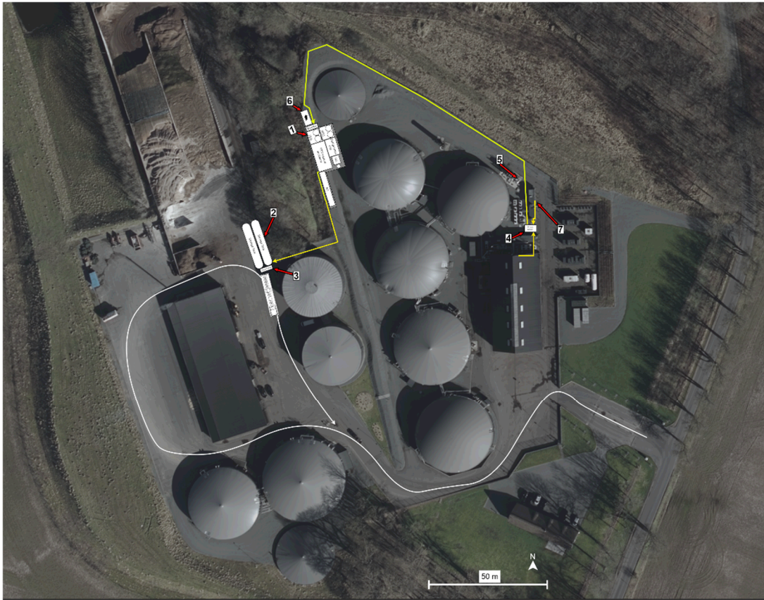
Figur 3. Illustration af CO 2 -fangstanlægget med placering af de forskellige komponenter. (1) Hovedområdet for procesanlæg, (2) CO 2 -oplagstanke, (3) CO 2 -påfyldningsstation, (4) CO 2 blæserenhed, (5) Aktivt kulfilter, (6) Strømforsyning (elkiosk) og (7) Eksisterende opgraderingsanlæg for biometan og skorsten. Den gule linje med pile viser flowet af CO 2 . Kørevej til påfyldningsstation er eksisterende.
