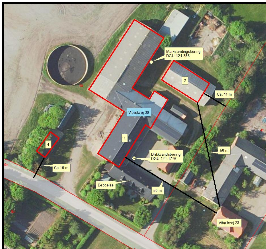
Figur 3. Manglende overholdelse af afstandskrav.
