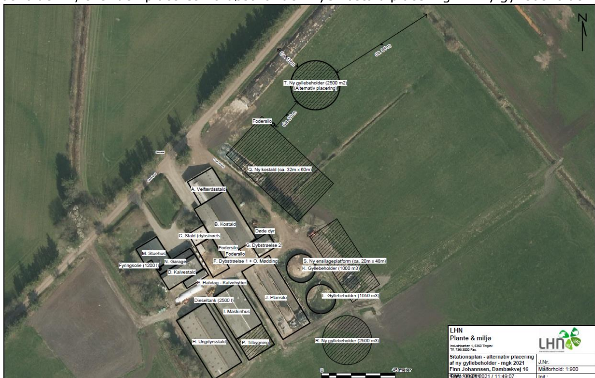
Figur 1. Oversigt over stalde, pladser og opbevaringsanlæg med 2 alternative placeringer af den nye gyllebeholder enten syd for eksisterende gyllebeholdere eller nordøst for den nye stald.
