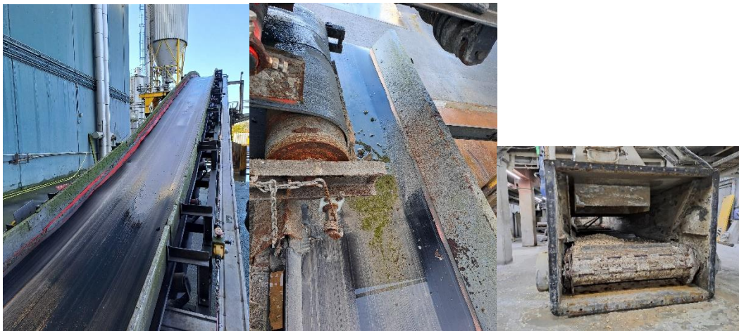
Figur 23, 24 og 25 – tv. Slaggebånd udenfor, midt. slaggebånd på slaggecontatiner, th slagge på Mayfran transportbånd.
