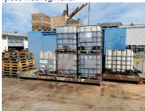
Korrekt oplagring til farligt affald.
