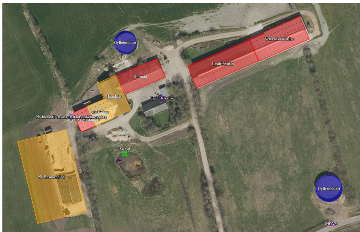
Figur 1. Oversigt over stalde, gødningsopbevaringsanlæg og øvrige anlæg.
