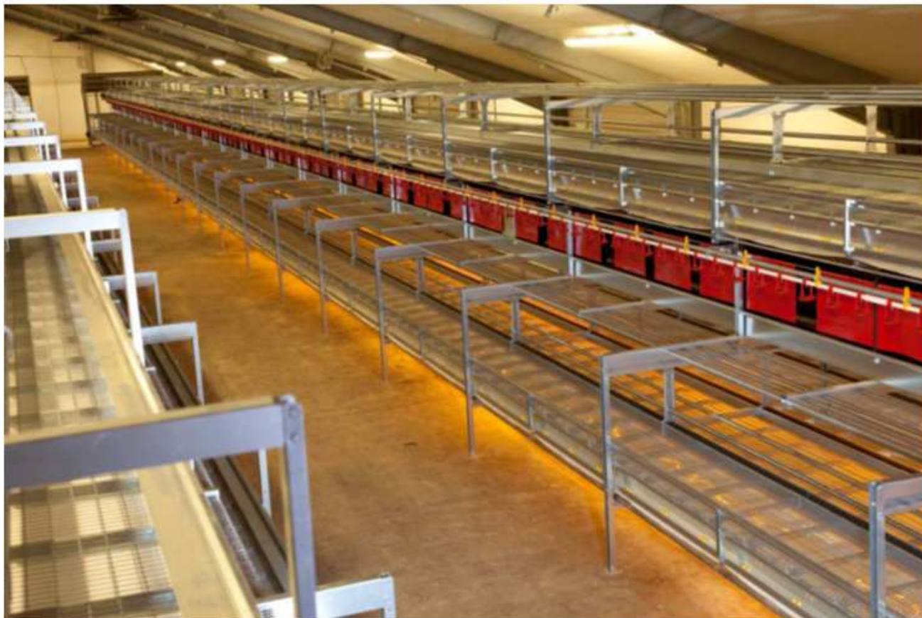
Figur 4 etageanlæg til æglæggende høner
