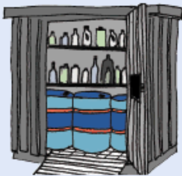
Figur 2: Udendørs opbevaring i container med dobbelt bund.
