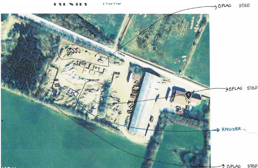
Figur 10. Indretningsplan for nedknusning på ejendommen.
