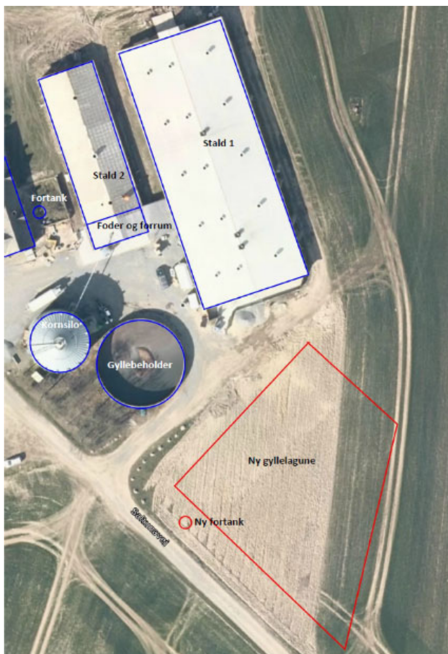
Figur 3 Anlægget på Sandegård
