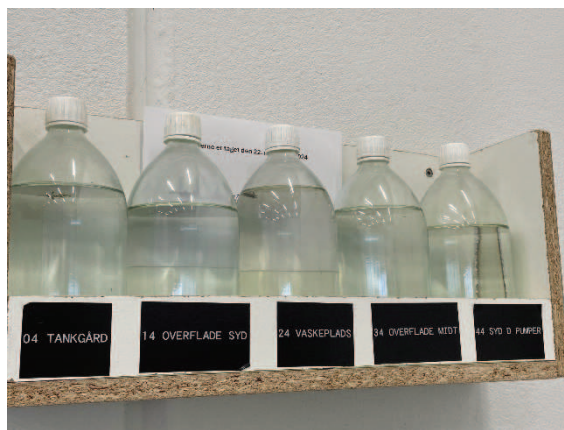
Kedelrum, vandprøver udtages fra olieudskillere én gang månedlig, afledes til recipient
