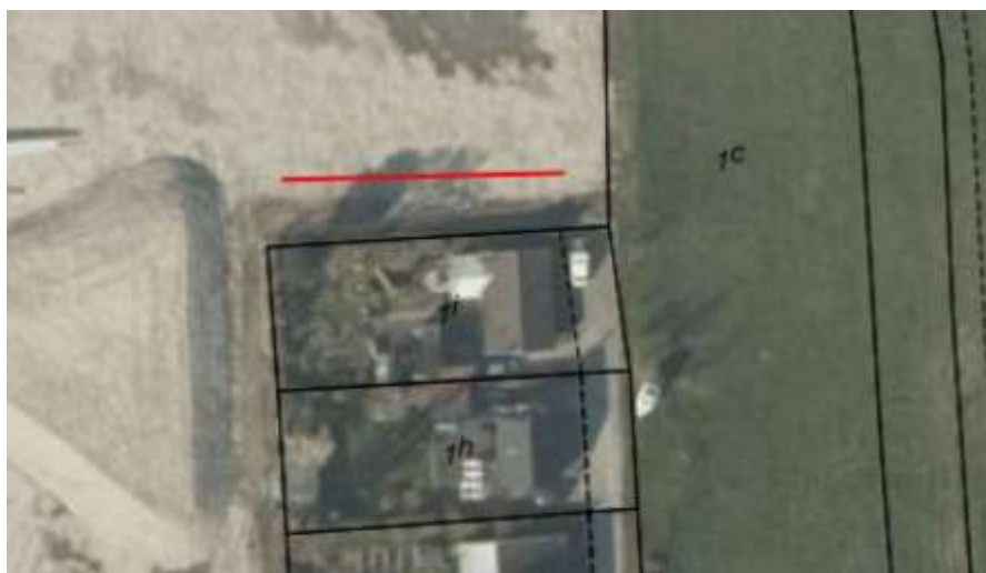
Foto: Rød streg markerer, hvilket stykke af volden, der er etableret – mangler dog markeringsnet og ren overjord.
