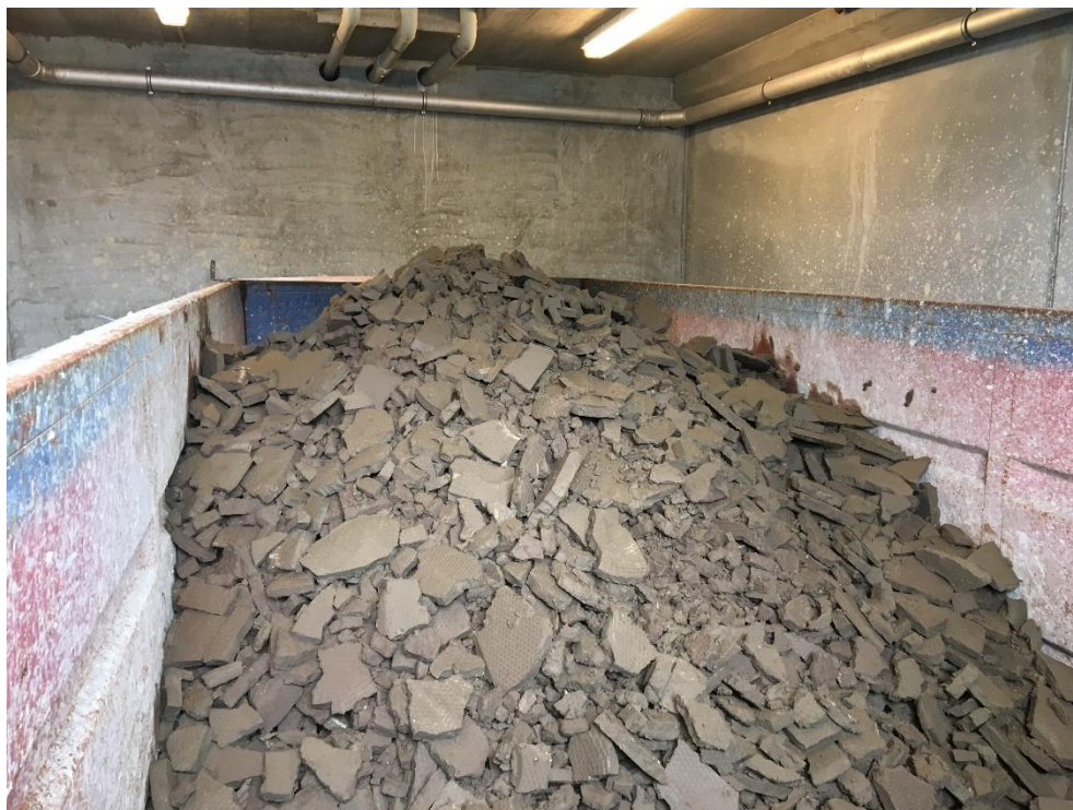
Figur 2-6 Filterkager fra spildevandsrensning, i indendørs container.
