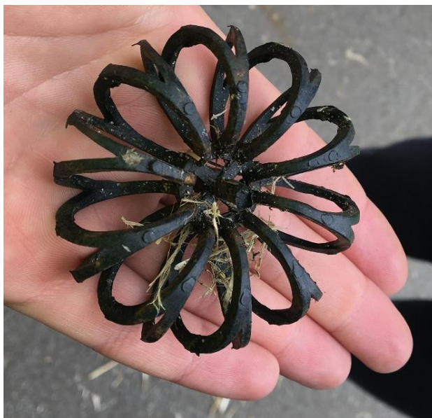
Figur 2-3 ADIOX-plastfyldlegeme til fjernelse af dioxiner i røggassen.
