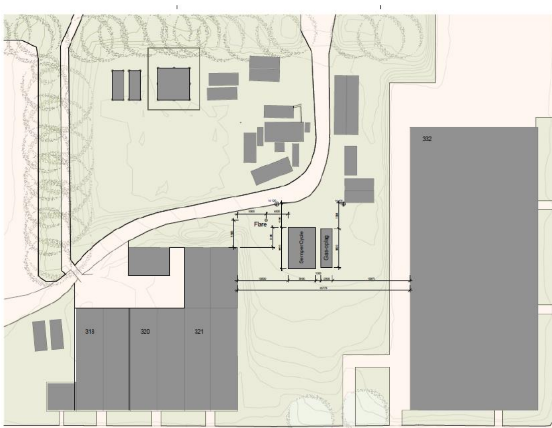
Figur 2. Placering af forsøgsopstilling og 14 meter høj flare i forhold til omkringliggende bygninger på Risø Campus
