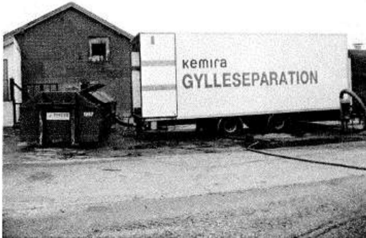
Figur 6. Mobilt separationsanlæg og container til fiberfraktion.
