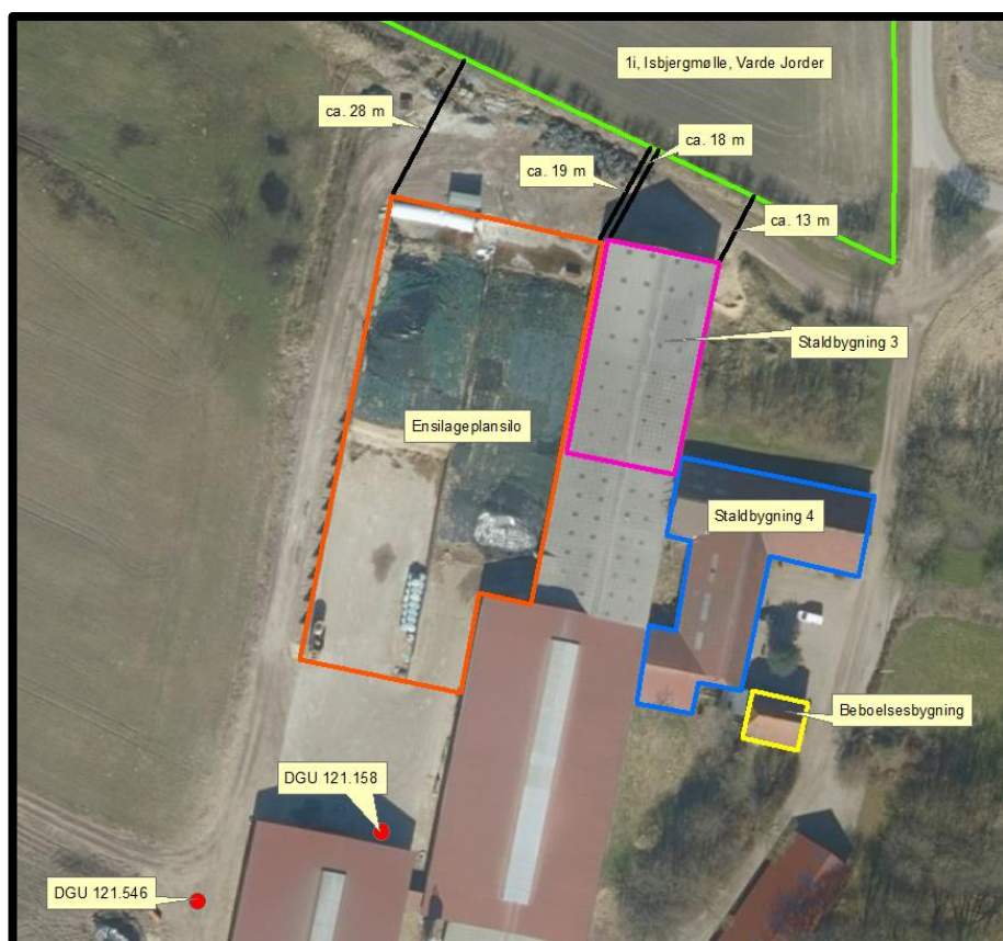
Figur 2. Manglende overholdelse af afstandskrav, borer, beboelse og naboskel.
