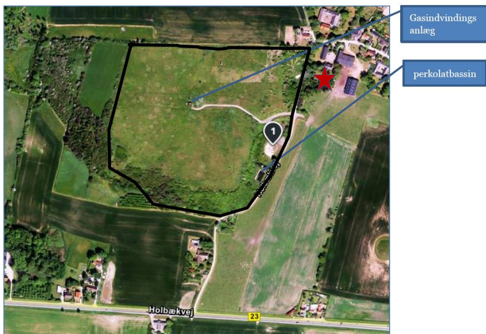
Fig. 1 Omtrentlig afgrænsning af Ubberup Losseplads Rød stjerne angiver omtrentlig placering af besigtiget monitoringsboring
