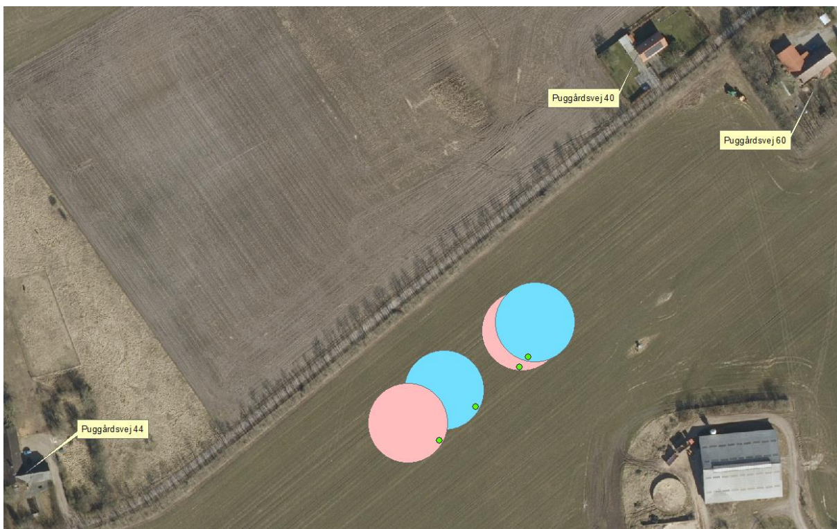
Kort 4: Placering af åbninger i teltdug på to nye gyllebeholdere (blå farve). Grøn punkt angiver placering af åbningen/studsens. Rød farve angiver placering af anlæggene i alternativ 1 og 3.
