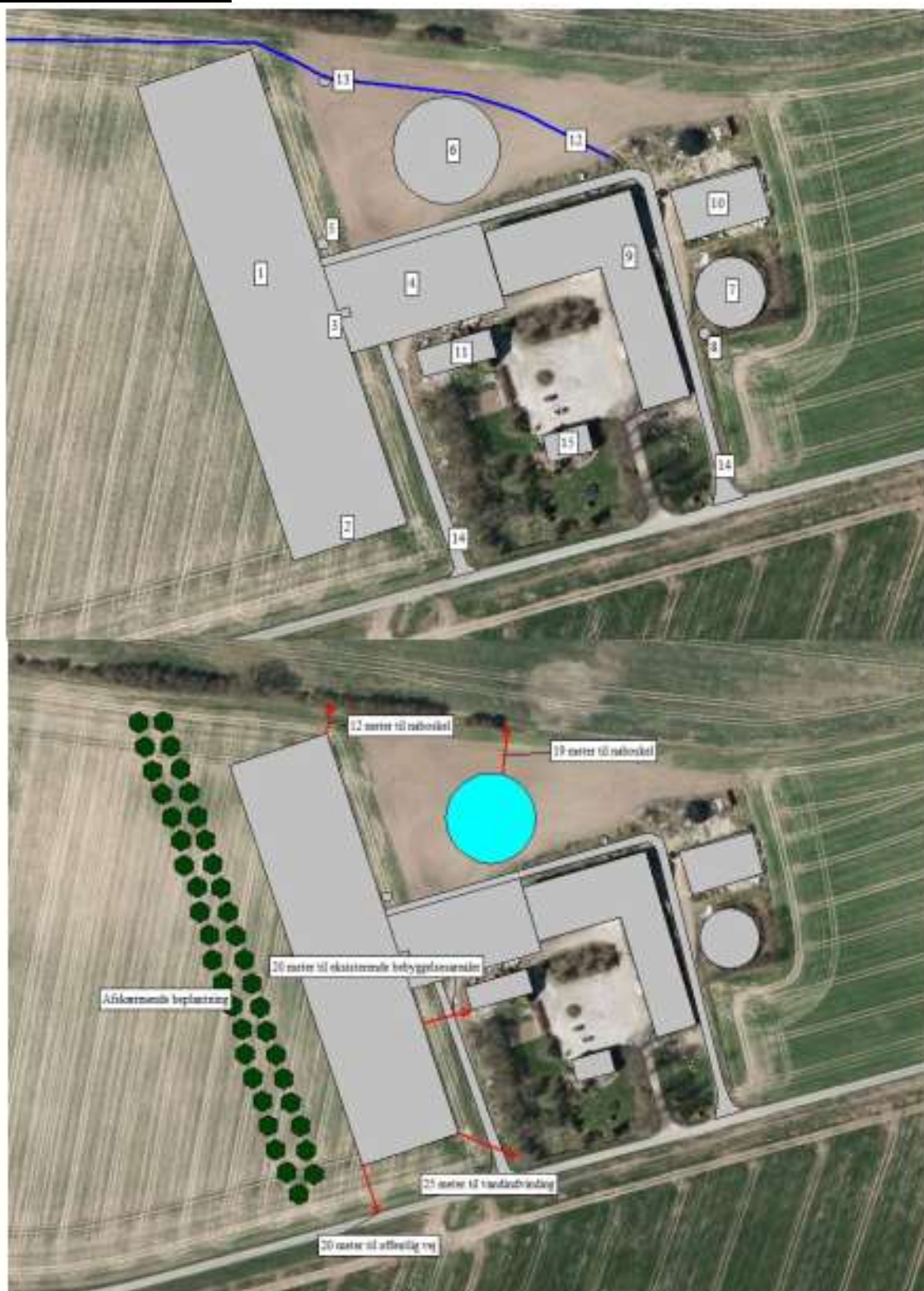
Figur B1: Plantegning og oversigtskort med relevante afstande og placering af afskærmende beplantning.
