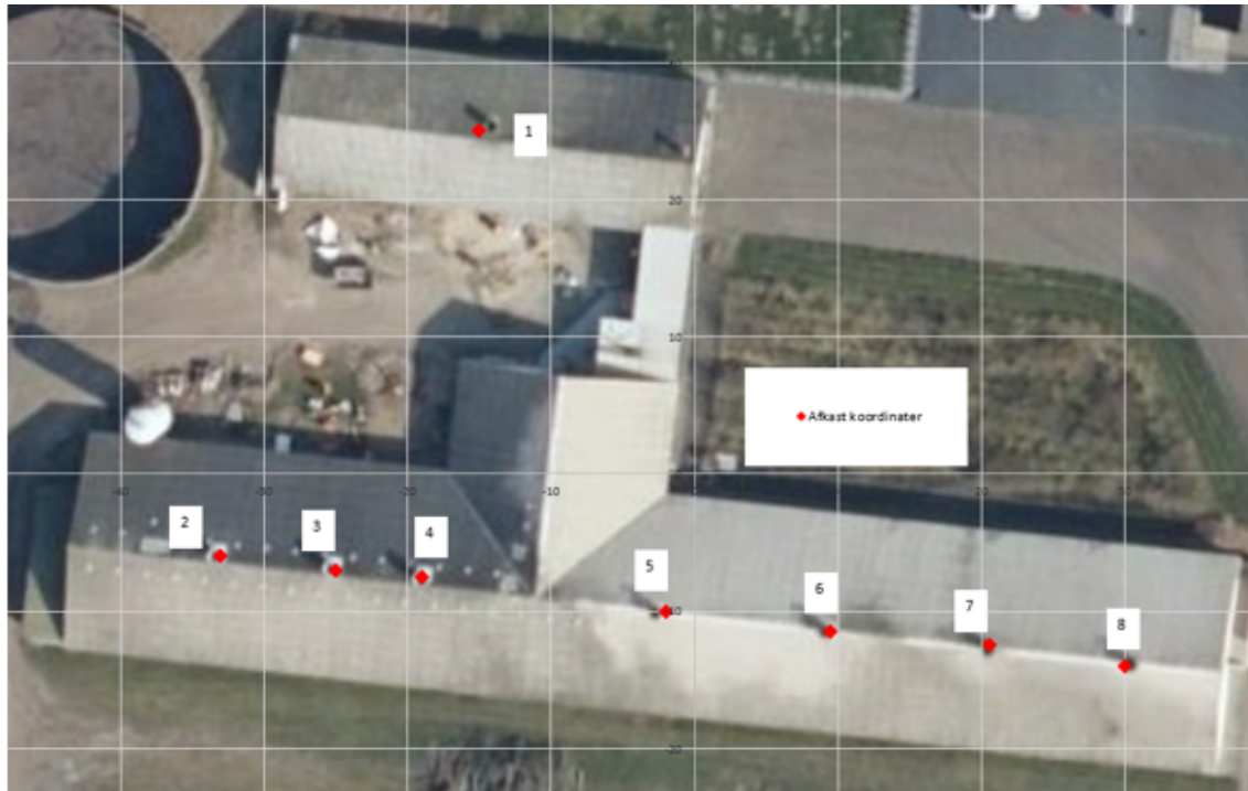
Figur 7 – placering af ventilationsafkast
