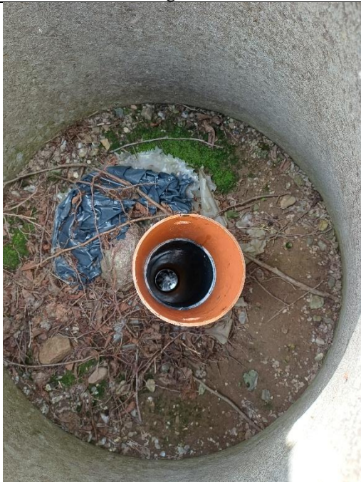
Deponi III. Boring GKB4 åbnet, grundvandet ligger så højt her at vandet kunne ses.
