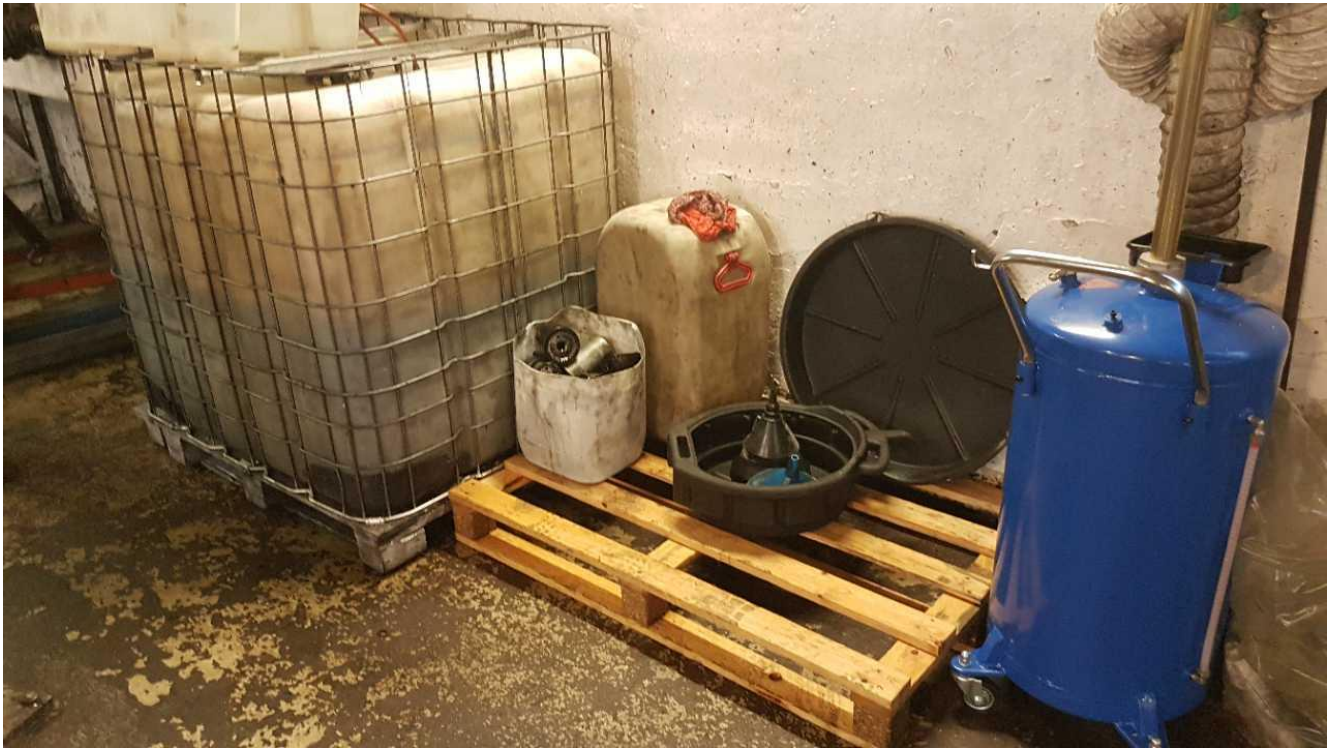
Opbevaring af spildolie i pallettank samt oliefiltere.
