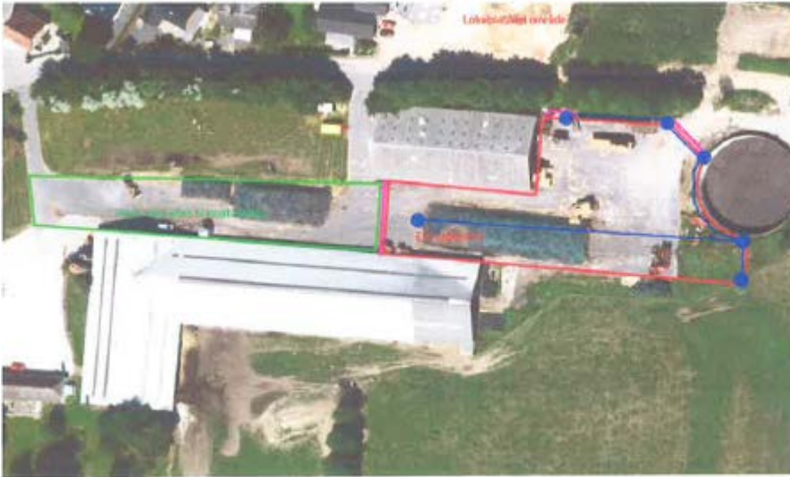
Skitse over af plads med afløb til kloak og ensilageplads med planlagte afløbsforhold til opsamlingsbeholder. Blå signatur er afløbsbrønde og -ledninger. Rød streg er afgrænsningen af ensilagepladsen.
