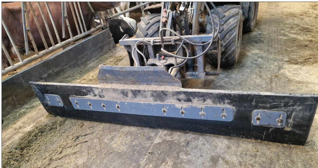
Figur 17: Skrabebledet til fordeling af foder er beklædt med gummi for at mindske støj i forbindelse med fodring
